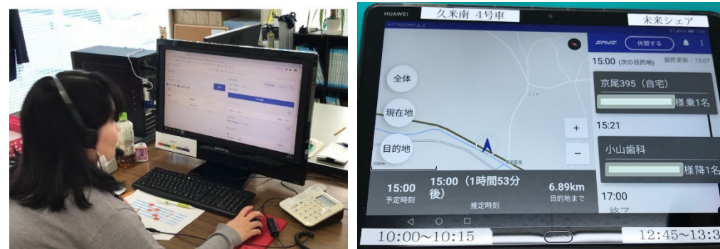
図 予約受付・配車ルートの車載タブレットへの表示状況
